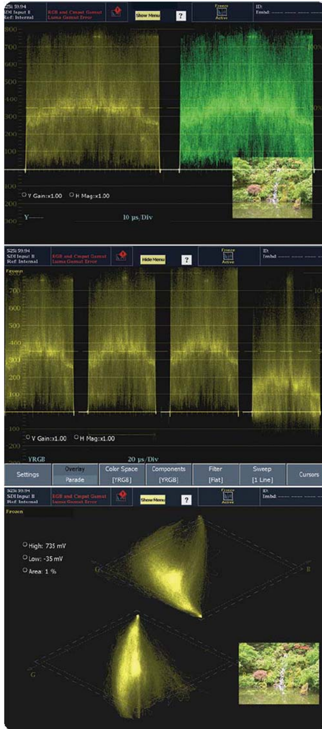
► 圖 1 WFM7100 的 CaptureVu 顯示 RGB 色域錯誤的影像擷取。這個顯示最初以 YPbPr 波形的形式擷取，然後重建為 YRGB 或 Diamond 顯示，以供進一步的分析之用。
