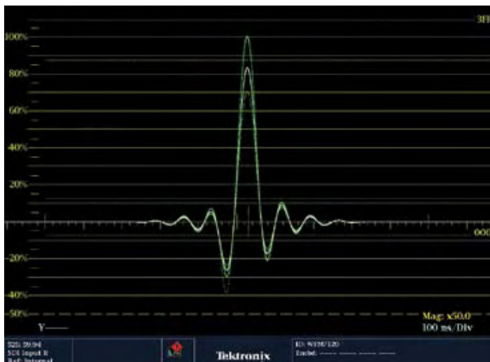
Рис. 28. Пакет опорных синхросигналов EAV (270 Мбит/с), отображаемый в виде аналогового сигнала яркости
