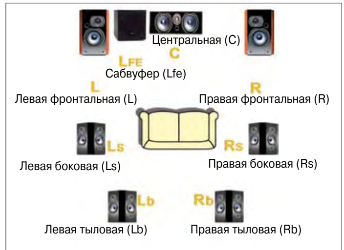
Рис. 60. Расположение акустических колонок в многоканальной системе объёмного звука
