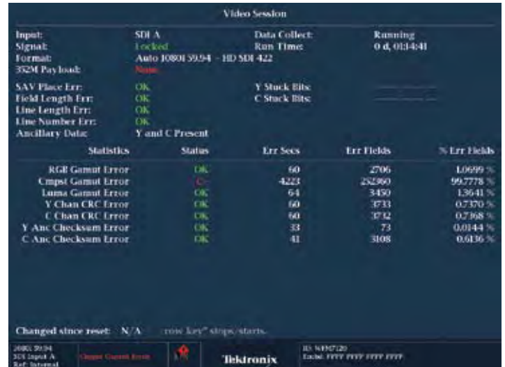
Рис. 80. Отображение значений CRC сигнала HD на экране монитора WFM7120 в режиме «Video Session»
