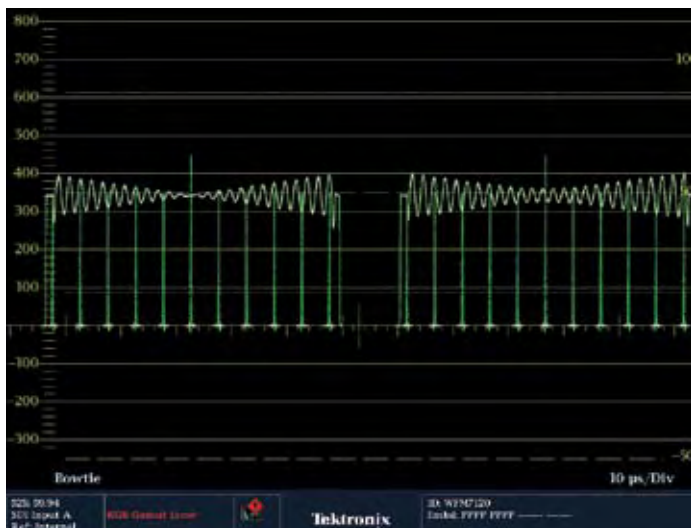
Рис. 94. Сигналы каналов Y и Pb (слева) и Y и Pr (справа)
