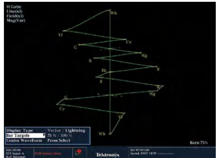
Рис. 104. Окно режима «Молния» с ошибкой усиления сигнала P'r
