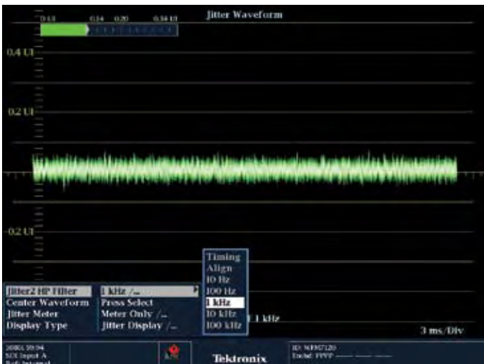
Режим измерения джиттера с фильтром 1 кГц
