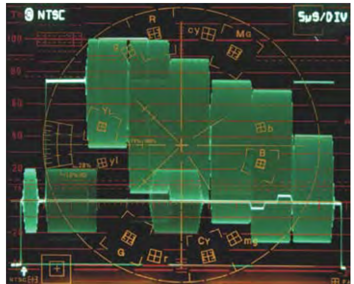
Рис. 70. Правильно настроенная амплитуда композитного видеосигнала формата NTSC, без защитного интервала
