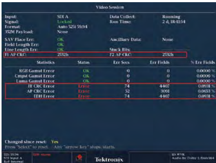
Рис. 79. Отображение значений EDH сигнала SD на экране растрейзера WVR7120 в режиме «Video Session»
