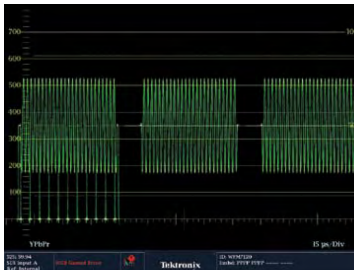
Рис. 93. Испытательный сигнал «Bowtie» («Бабочка»)
