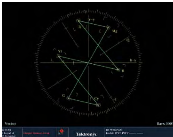
Рис. 99. Окно режима вектороскопа сигнала NTSC
