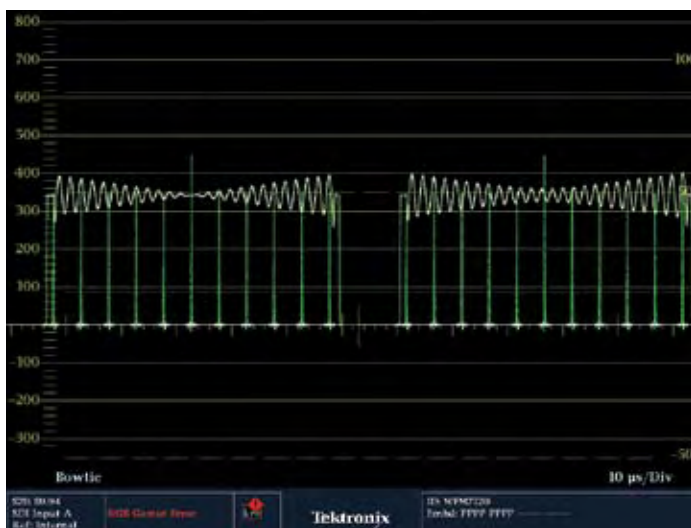
Рис. 96. Окно режима «Bowtie», ошибка усиления в канале Pr относительно Y
