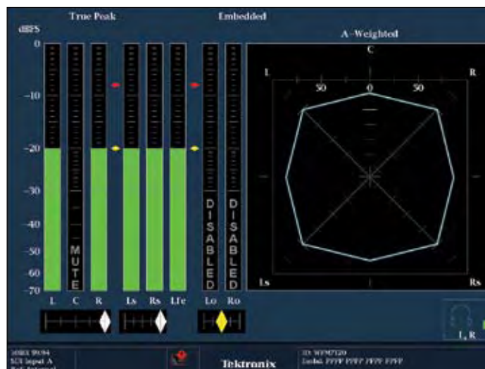
Рис. 61. Окно режима контроля параметров объёмного звука с тестовыми тонами для каналов L, R, Ls и Rs
