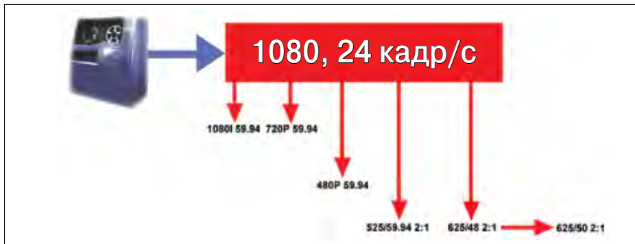
Рис. 32. Процесс перевода кинофильма в цифровой видеоформат высокой чёткости
