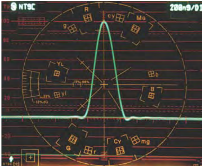
Рис. 75. Корректный измерительный импульс 2Т, окно 1Н MAG
