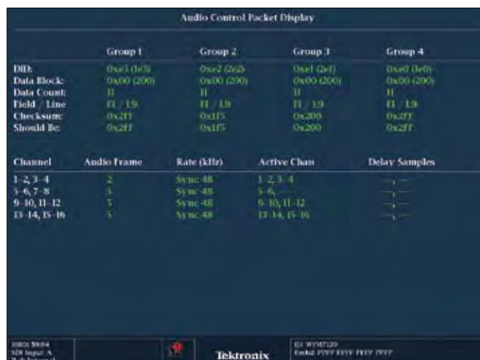
Рис. 59. Окно контрольного аудиопакета растрейзера сигналов серии WVR
