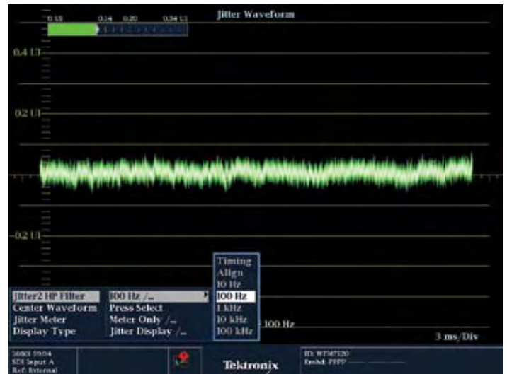
Режим измерения джиттера с фильтром 100 Гц
