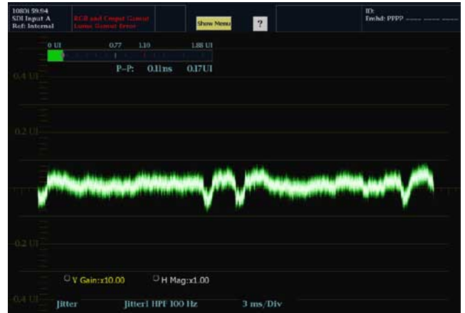
100Hzの (HP) フィルタによるジッタ表示
