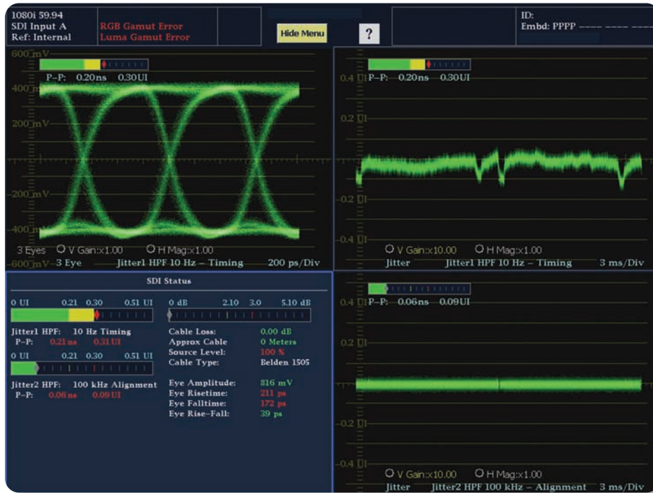
▶ 図13： タイミング・ジッタとアライメント・ジッタの同時測定例
