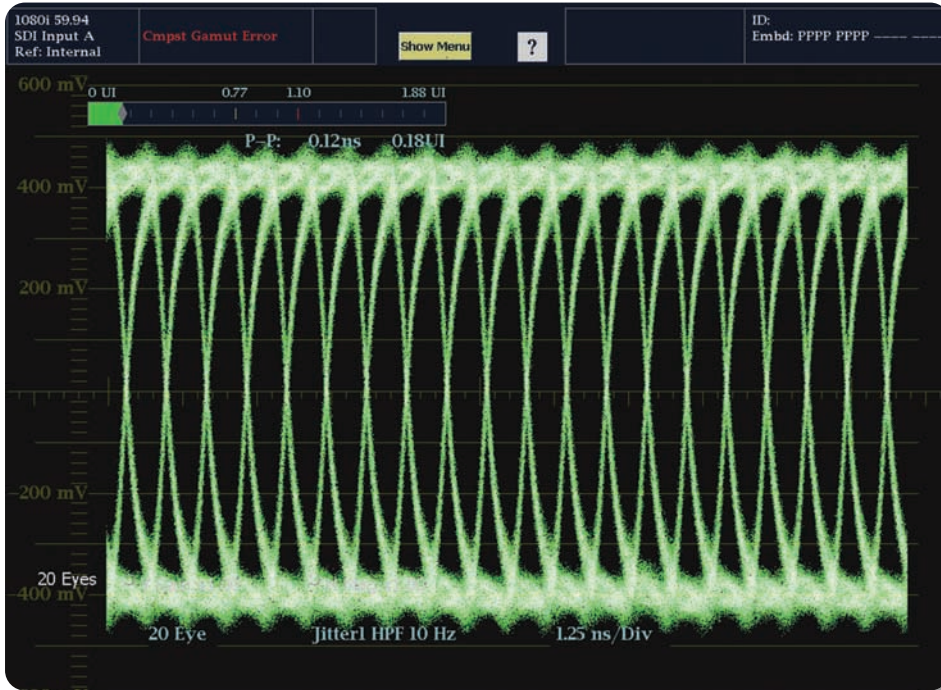
▶ 図17：HD信号の20アイ・パターン表示例
