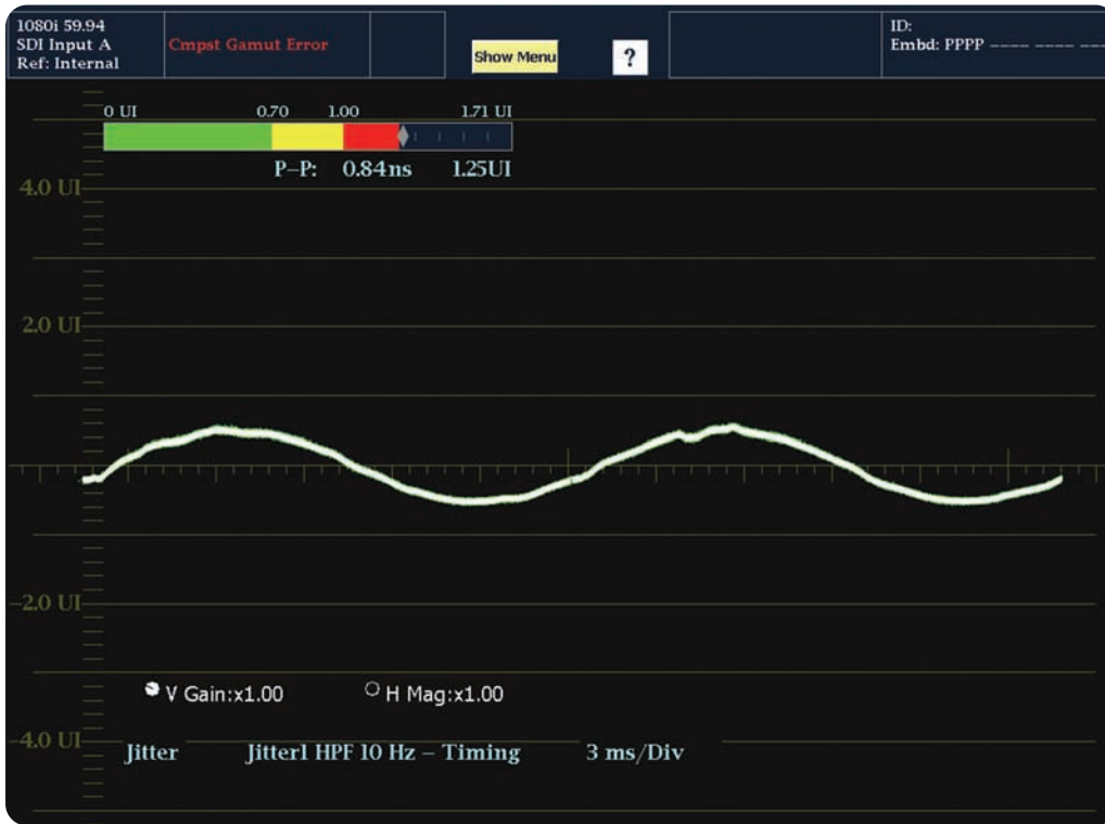
▶ 図12：電源周波数60Hzのジッタ波形表示例
