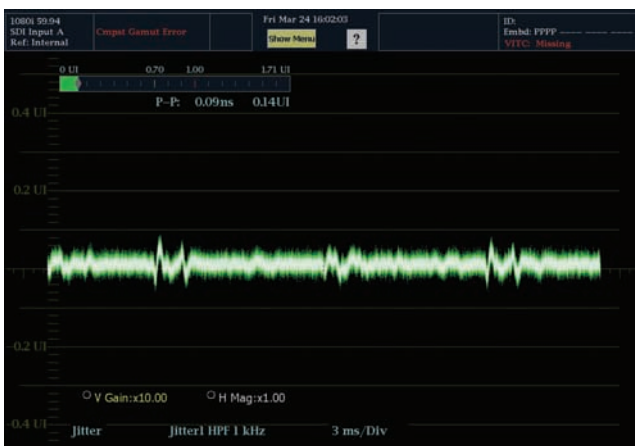
1kHzの (HP) フィルタによるジッタ表示
