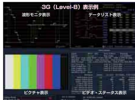
3. 3G-SDI (Level-B) の観測例；VPIDに基づいてフォーマット検出できる。波形・ベクトル・ピクチャ・ガマット・ステータスなどが観測できる。
