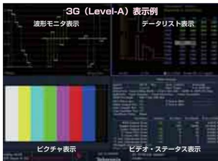
2. 3G-SDI (Level-A) の観測例；VPIDに基づいてフォーマット検出できる。波形・ベクトル・ピクチャ・ガマット・ステータスなどが観測できる。
