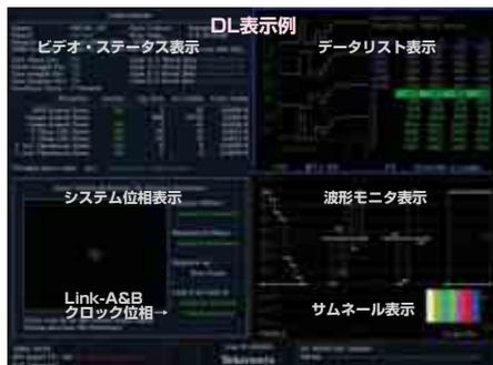
1. DL信号の観測例；VPIDに基づいてフォーマット検出できる。Link-A&B間のクロック位相が測定できる。
