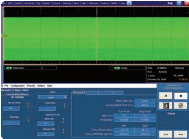
▶ 図28：VM6000型の水平同期信号ジッタ測定例
