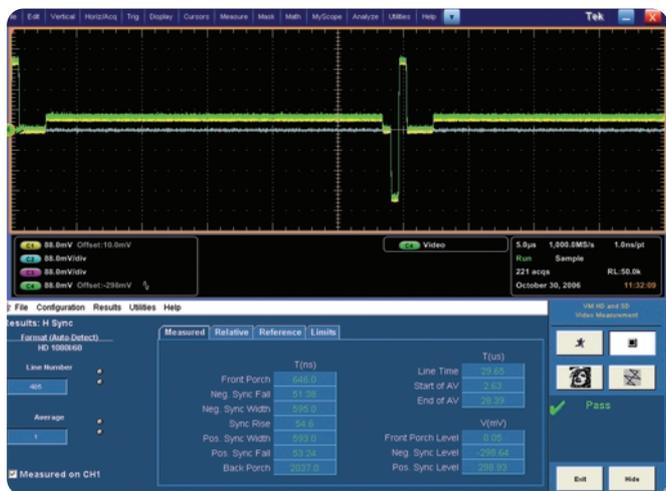
▶ 図23：HD信号の水平同期信号測定例
