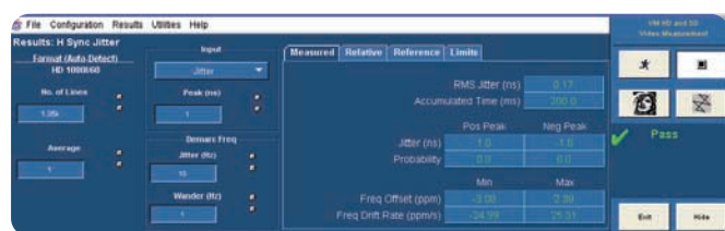
▶ 図6：VM6000型による水平同期信号のジッタ測定例
