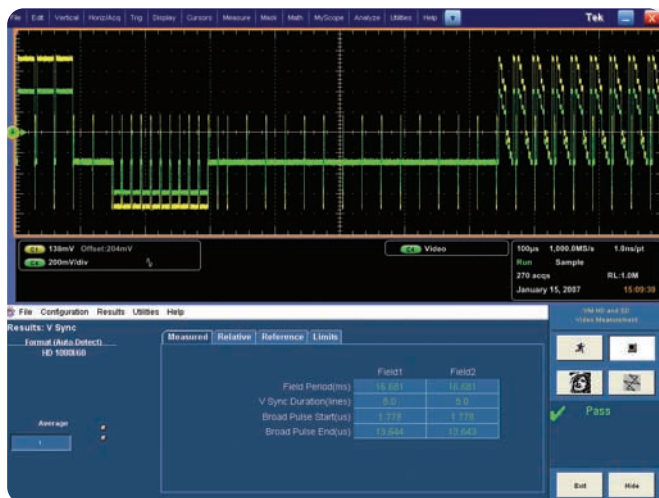
▶ 図4：VM6000型によるHD垂直同期信号の測定例
