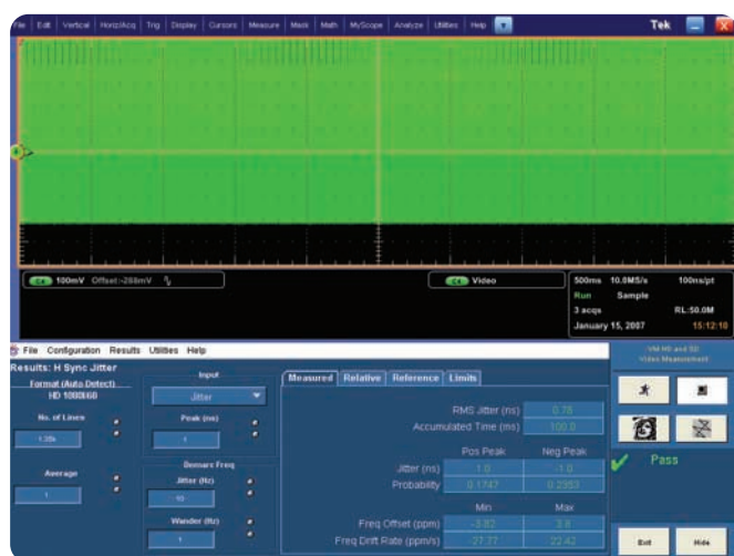
▶ 図5：VM6000型による水平同期信号のジッタ／ワンダ測定例
