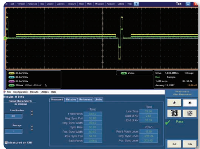
▶ 図3：VM6000型によるHD水平同期信号の測定例
