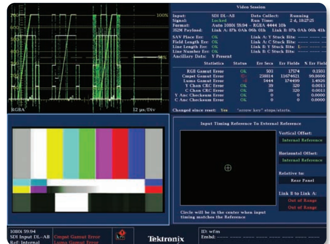
▶ 図15： Link AとB間のチャンネル間タイミング
