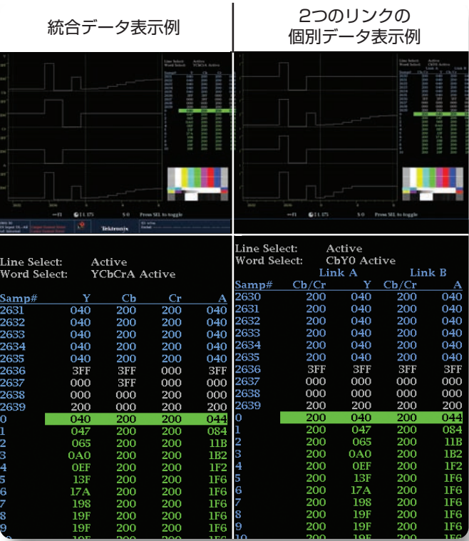
▶ 図5：リンクABの統合データおよび個別データの表示例
