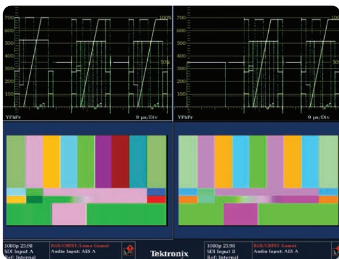
▶ 図3：R'G'B' (A) 4:4:4:4フォーマットのDual Link AおよびB信号の波形表示例
