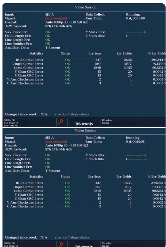
▶ 図11: WFM7120型のVideo Session表示によるLink AおよびBのエラー・メッセージ例
