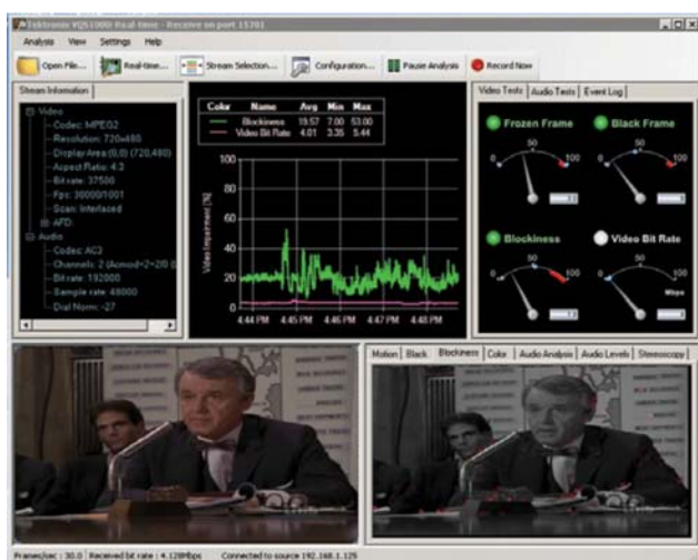
图10. 由卫星分配系统馈送来的信号中有着不太严重的块效应图像。
