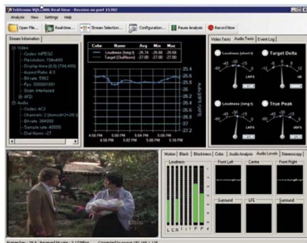
图 14. 有线电视的音频响度高于对白归一化电平 2 dB, 这通过卫星馈送节目时音频响度提高到 4 dB。
