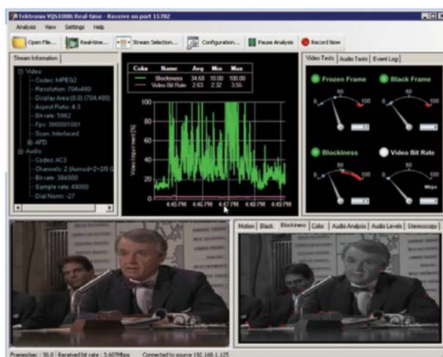
图11. 在同一时间帧上经过转码后的内容有着明显较高的块效应现象(绿色曲线)。
