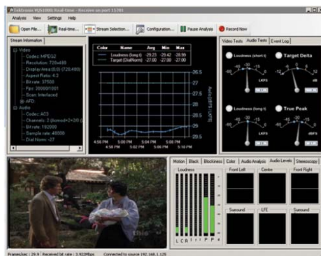
图 13. 利用消音装置, 使来自卫星的采集节目的音频响度比对白归一化电平降低 2dB。
