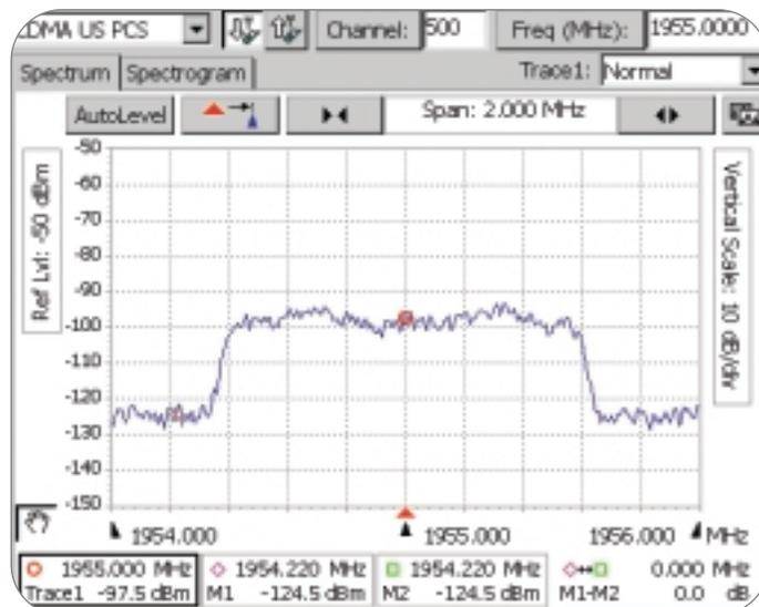
► Figure 23. CDMAOne (using 2 MHz span).
