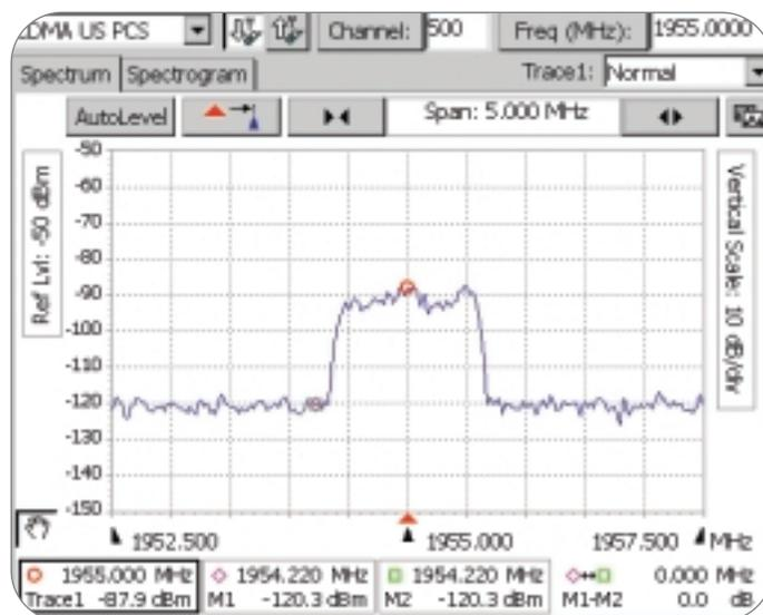
► Figure 22. CDMAOne (using 5 MHz span).
