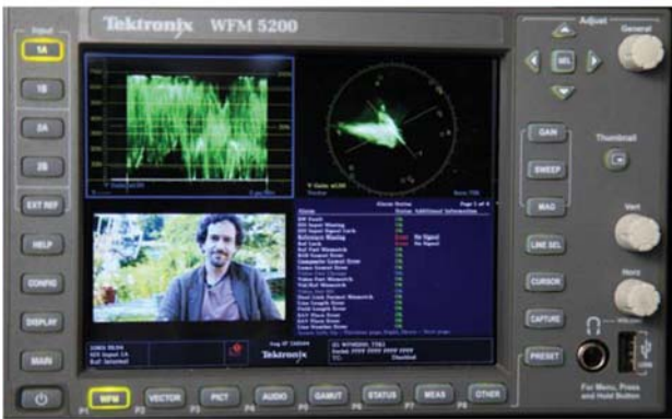
图 15. 波形监测仪上的捕获(Capture)按钮位于面板右方的底部。
