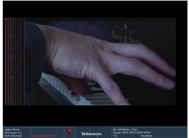
图2. 这是一幅失去白平衡的图像。利用泰克公司的捕获功能,将对这幅图像进行校正处理, 以与图1中的图像相匹配。
