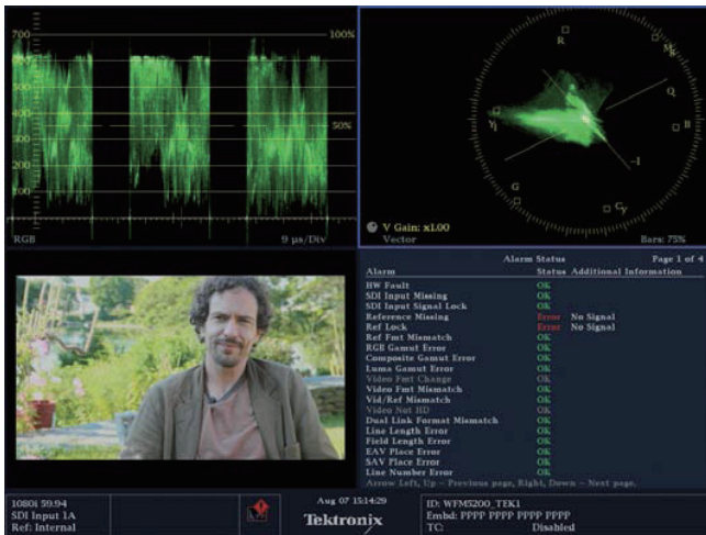
图3. 带有选件CAM的WFM5200，允许四路信号输入。
