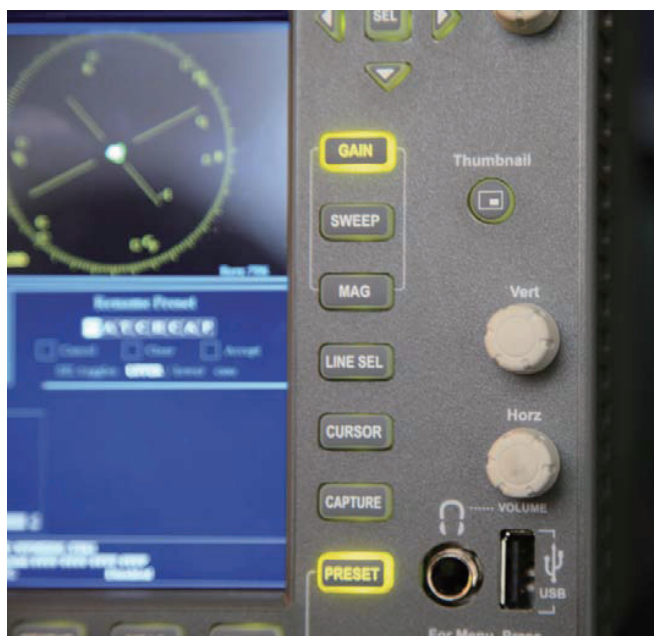
图17. 在WFM5200的前面板上分布了许多旋钮和按键, 这样您就可以迅速地方便地使用最常用的功能。
