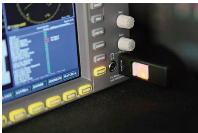
图22. 从您的计算机上取出U盘之后，将它插入到WFM5200或者其它泰克公司波形监测仪前面板的USB端口上。
