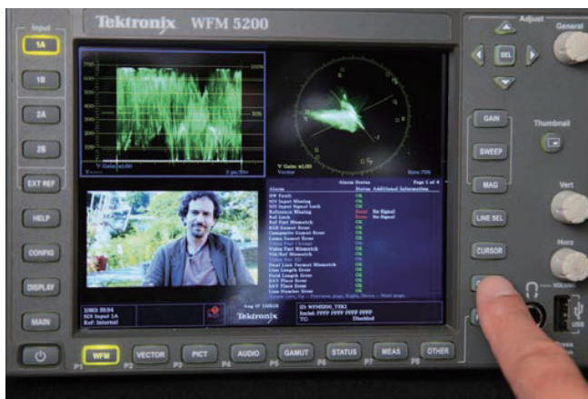
图23. 按下仪器上的preset按钮并保持几秒钟，该按钮位于USB端口的旁边。
