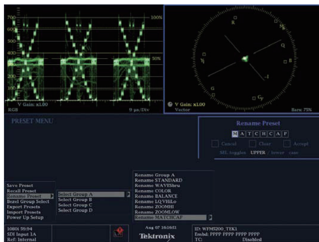
图16. 注意仪器屏幕的底部附近给出的菜单信息, 它表明用户均可以对每个预置项给出表示一定意义的自定义命名, 而不是仅用数字来指示区分各个预置项。
