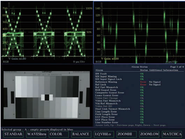
图9. 本图的左上方是标准的RGB波形并列显示，而右上方给出的是此RGB波形放大后的显示图形，并且对其再次在屏幕上定位以显示RGB波形的高光(白电平)部分的细节。
