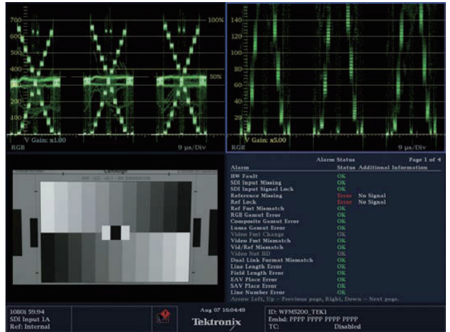
图10. 本图的左上方是标准的RGB波形并列显示，而右上方给出的是此RGB波形放大后的显示图形，而后对其再次在屏幕上定位以显示RGB波形的阴影(黑电平)部分的细节。
