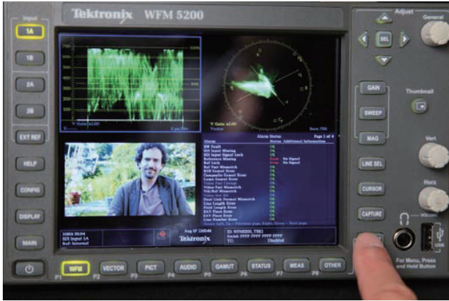
图18. 预置项的再调用可以通过按两次按钮来实现。首先按下 Preset按钮(它在本图手指处的下方), 而后按下与您要求的预置项相对应的软键即可。注意这些软键均呈一行分布在波形监测仪面板的底部。
