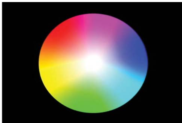
图 16. 由图 15 中上圆锥体的顶部向下观察 RGB 彩色空间的显示效果。
