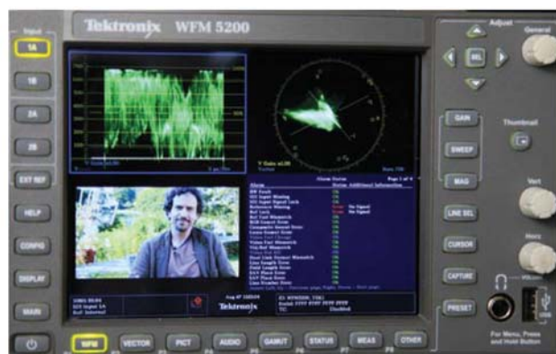
图5. 泰克公司的波形监测仪能够提供包含多种信息的显示窗口，并且完全可以由用户自行定义各分屏窗口的显示配置，以充分发挥仪器的最大效能。
