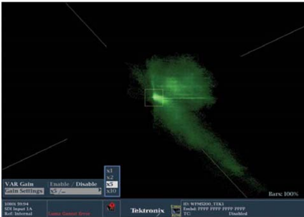
图7. 泰克公司波形监测仪能够方便而又迅速地在各种波形显示中对图像进行缩放、(垂直)增益调整和(水平)扩展,例如本图给出的是5倍放大率的矢量显示。
