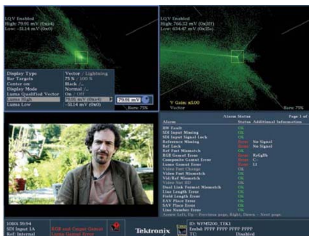
图 12. 在 LQV 显示图形中用户可以对图像灰度显示范围的设置菜单自行定义。在本图中可以看出，显示图像中阴影部分的灰度范围是从 0 mv 直至 79.91 mv。
