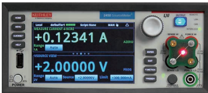
図1. 2450型ソースメータを使用し、赤色LEDのI-V特性を測定した例
