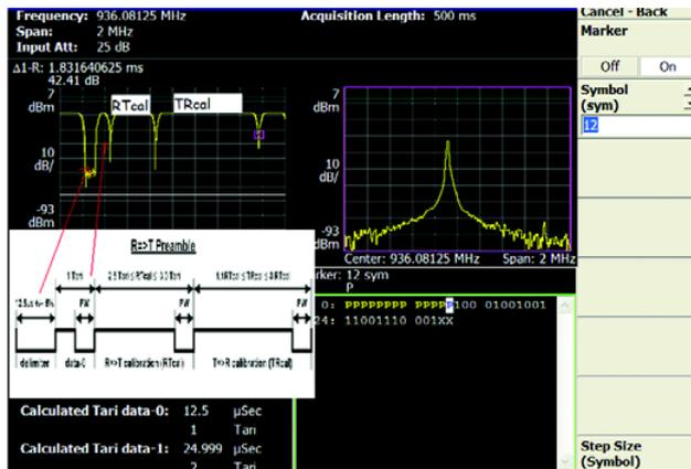
图 22. ISO18000-6C 阅读器信号前置码中包括的关键定时参数。
