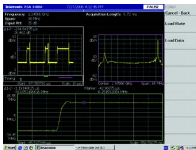
■ 图 6：图上看到三个窗口，左上的是功率对时间的显示（时域），右上的窗口是功率对频率的显示（频域），下方的窗口是频率对时间的显示（调制域），从下方的窗口上可以看到频率捷变的时间为 1.19 \mu s。另外该仪器提供自动测量功能可以将频率转换时间自动测量出来。
