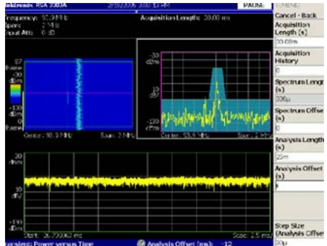
■ 图 16. TIF 电平保持不变，FMT 则捕获低功率间歇发射机频谱图。恒定 IF 电平意味着不能使用传统 IF 功率电平触发。
