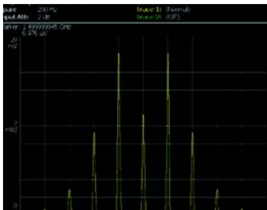
■ 图 5(a). 拥有以 20 Hz 调制的 1.5 GHz 载波及调相幅度为 1.75 弧度的调相信号的频谱。
