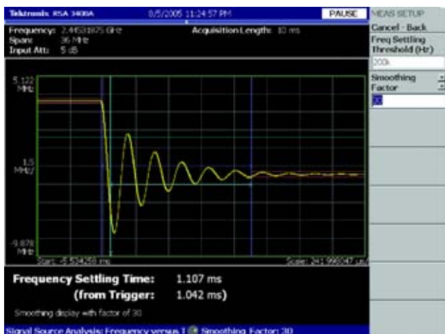
■ 图 6. 实时频谱仪测试换频时间图，这里换频时间自动测量 (Frequency setting time) 值为 1.107ms。
