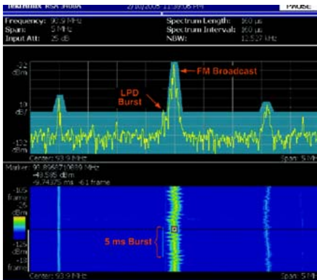
■ 图 17. 当存在多个强大的 FM 广播无线电台时, FMT 触发捕获隐藏的低电平传输。这个 LPD 突发的功率几乎要低 100,000 倍或比强大的 FM 信号低 50 dBc, 且仅长 5 ms, RTSA 触发和捕获了这个 LPD 突发, 并进行分析。
