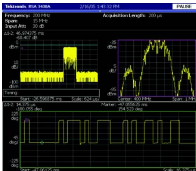
■ 图 27. 在双相调制的压缩脉冲上检查 180° 相位转换。
