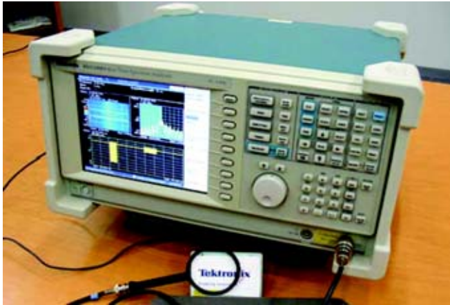
■ 图 1. 使用RSA3303A和近场探头(泰克产品编号: 119-4146-00)测试 RFID 阅读机和标记之间交互情况的设置实例。
