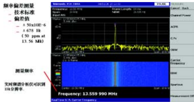
■ 图4-16. 通过“Carrier Frequency”键进行载波频率测量，在屏幕下端直观地显示测量结果
