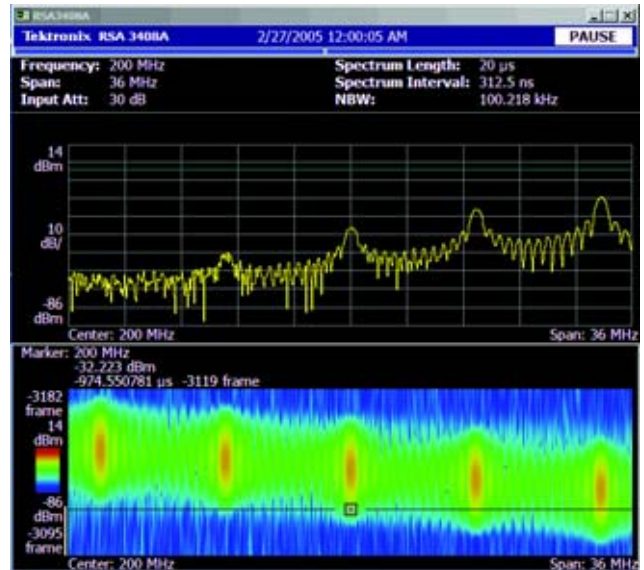
■ 图 16. 重叠 FFT 可以有效查看跳频雷达。
