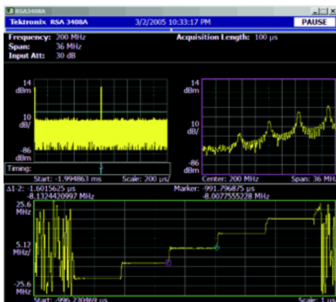
■ 图 12：对脉内的跳频进行解调分析
