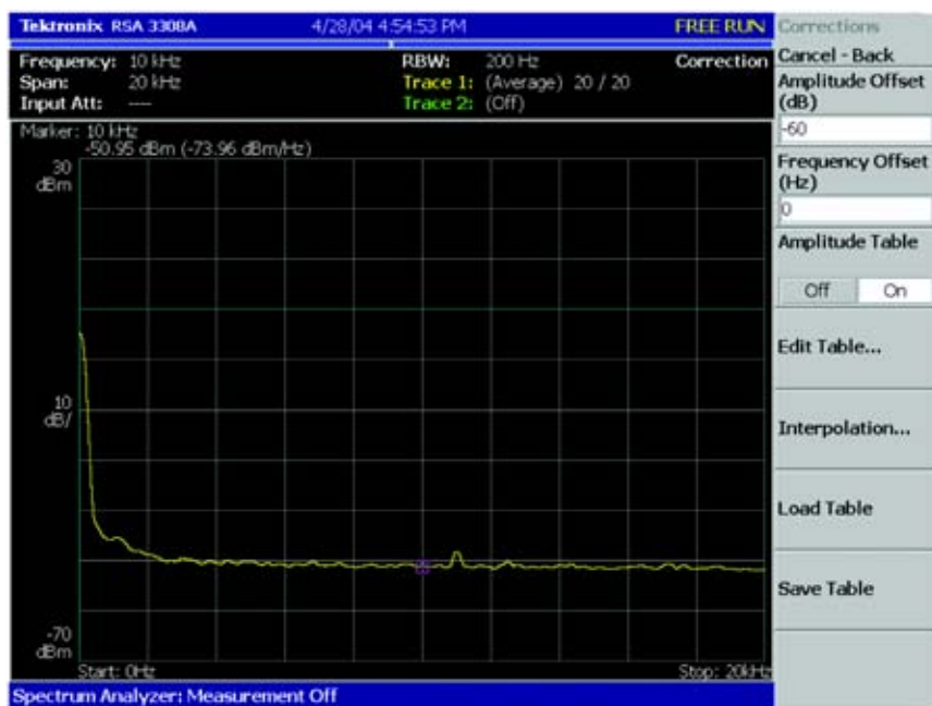
图 12. RSA3308A 实时频谱分析仪在音频 DC – 20 kHz 跨度时显示的 P5200 差分高压探头上 1/500 范围的本底噪声(1300 V 最大)。
