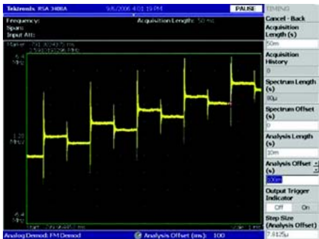
■ 图 15.这是用调制域跳频信号，横周是时间，纵轴是频率，所以只需要添加 2 个光标就可以测出跳频速率。
