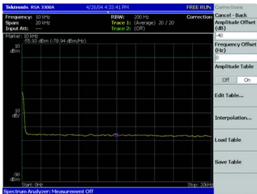
图 11. RSA3308A 实时频谱分析仪在音频 DC – 20 kHz 跨度时显示的 P5200 差分高压探头上 1/50 范围的本底噪声(130 V 最大)。
