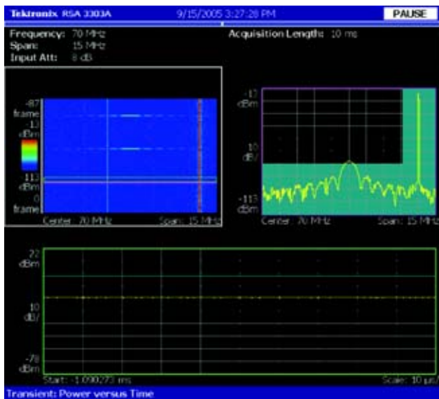
■ 图 5：实时频谱分析仪的频率模板触发器从接收机的 70MHz IF 可靠的捕获雷达脉冲，其功率远远低于只在 IF 上方看到的下变频局部振荡器的(LO)泄漏。绿色区域是为了仅仅捕获脉冲信号而设定的频率触发模板，在这里设定的触发条件是只有当信号进入的黑色区域才会形成触发事件。我们看到脉冲频谱已经超出了模板，满足了触发条件。图中使用的多域显示，除了频谱，还有时域和解调域我们会在后面介绍多域观测的相关内容。
