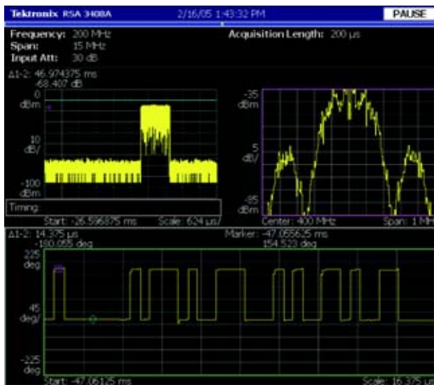
■ 图 13: 相位编码雷达信号
