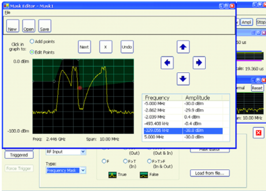
■ 图 4. 可以任意绘制 FMT，捕获发生频次低的事件。在本例中，可以以一致的方式触发发生频次低的跳频。这种独特的功能特别有助于调试间歇性问题。
