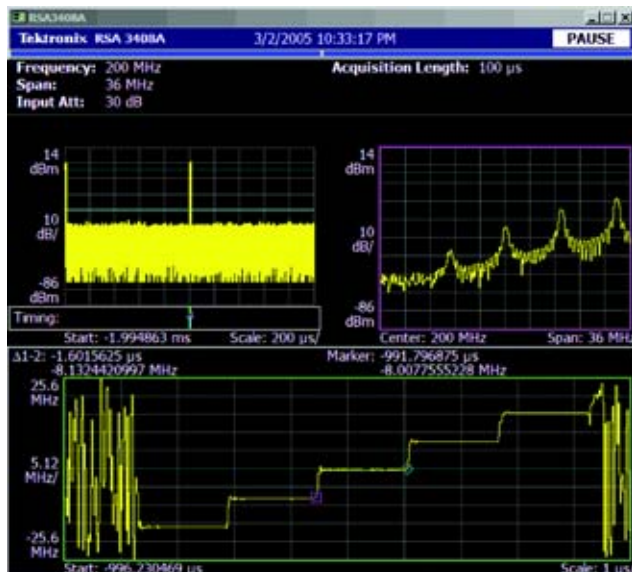
■ 图 26. RTSA 测量跳过五个频率的雷达脉冲。标尺显示跳频时长是 1.6 μs。
