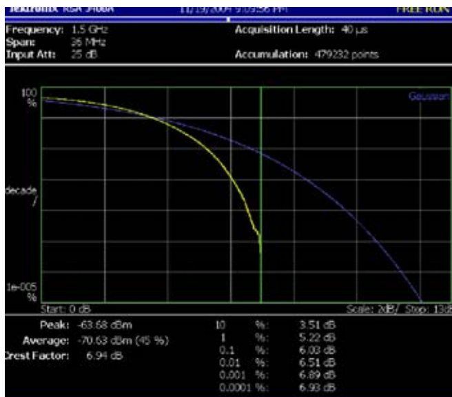
■ 图20. CCDF签名有助于确定哪种发射机及可能哪个序列号的设备生成了信号。
