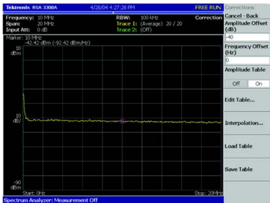
图 7. RSA3308A 实时频谱分析仪显示的 P5200 差分高压探头上 1/50 范围的本底噪声 (130 V 最大)。在 500 kHz – 20 MHz 时系统本底噪声 (参考探头输入) 低于大约 -90 dBm/Hz。分析仪本底噪声约为 -154 dBm/Hz (在分析仪输入上)。在探头中校正 40 dB 损耗时, 分析仪本底噪声约为 -114 dBm (参考探头输入)。因此, 探头噪声要高出 20 dB 以上。但是, 高输入阻抗和高压功能可以使用 P5200 测量广泛的电源信号。
