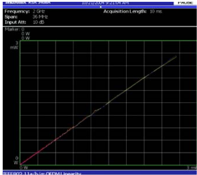
■ 图 8. 线性(backed-off)功放器设置正确的 OFDM 线性度测量。
