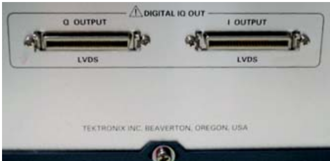
■ 图25. 在配备LVDS端口时，可以使用RTSA简便地连续实时提取I-Q记录。
