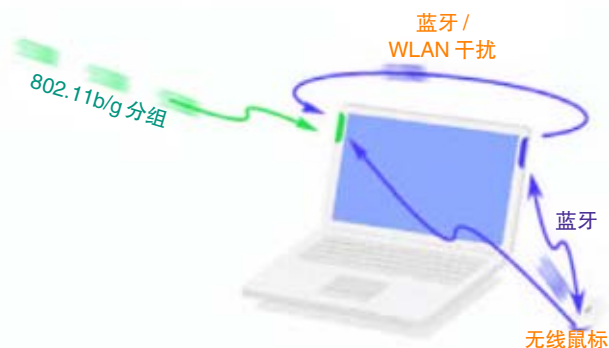
■ 图12. 802.11b/g信号分组与蓝牙信号分组发生碰撞。
