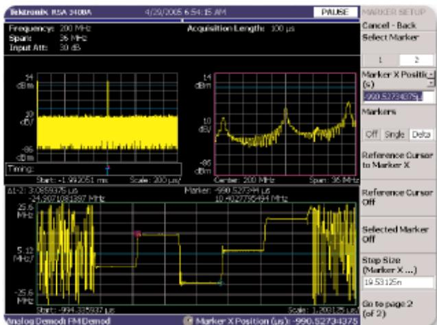
▶ 图 6. 频率随时间变化 - 伪随机跳频器。
