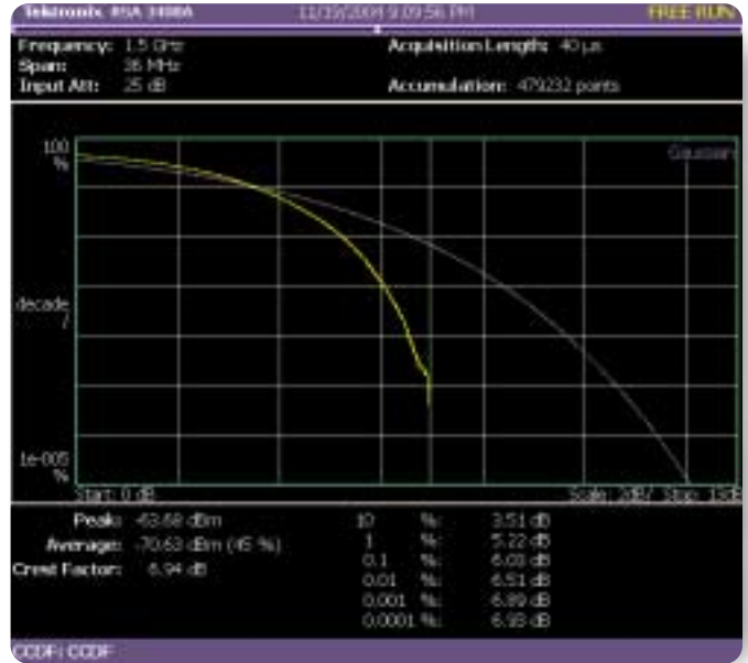
▶ 그림 20. CCDF 특성은 어떤 종류의 이미터가 해당 신호를 발생시켰는지 그리고 경우에 따라서는 신호를 발생시킨 장치의 일련번호를 판단하는 데 도움이 됩니다.
