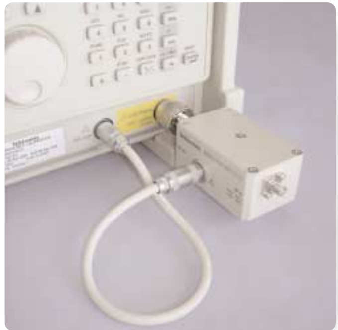
▶ 그림 11. 선택 사양인 RTSA 프리앰프는 분석기 노이즈 플로어를 낮추고 20dB의 이득을 추가하여 수신 성능을 향상시킵니다. RTSA로부터 프리앰프로 직접 전력이 공급됩니다.
