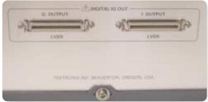
▶ 그림 25. LVDS 포트가 장착되어 있으면 RTSA를 이용해 실시간으로 연속해서 I-Q 레코드를 추출하는 작업을 쉽게 수행할 수 있습니다.
