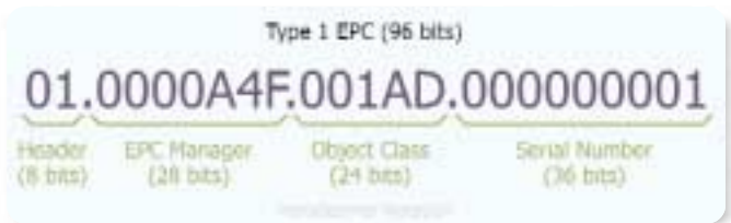
▶ 그림 3. 96비트 EPC 번호는 UPC 바코드보다 더 많은 정보를 담고 있습니다. 헤더는 EPC 번호의 형식을 나타내고 관리자는 회사를 나타내며 객체 클래스는 바코드의 SKU(Stock Keeping Unit)와 비슷한 것이고 일련 번호는 각 객체 클래스에 대해 680억 개 이상의 고유 품목을 나타냅니다.
