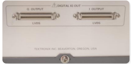
▶ 図25. RTSAはLVDSポートを搭載しているため、I-Qデータをリアルタイムかつ継続的にしかも簡単に抽出することができます。
