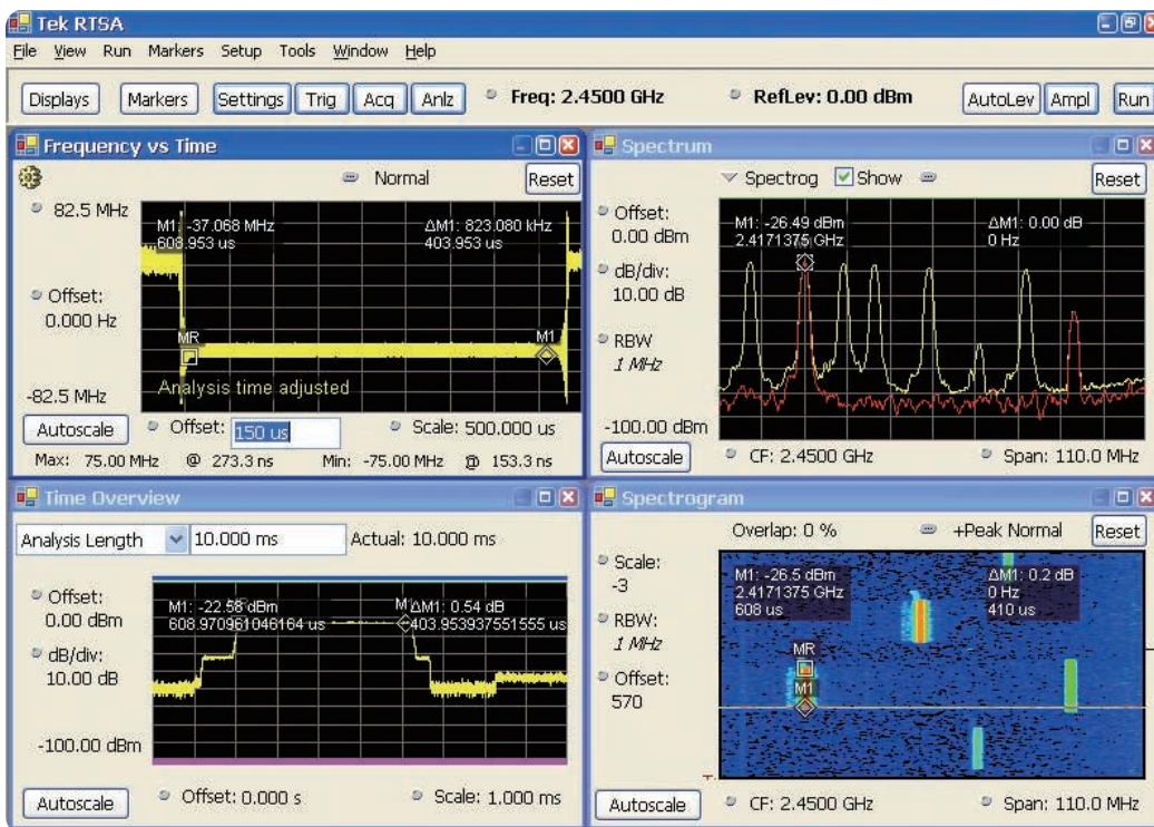
▶ 図9：Bluetoothの110MHzホッピング・シーケンス。左上から時計回りに、周波数対時間、スペクトラム（特定の時間における赤のスペクトログラム波形のもの）、スペクトログラム、パワー対時間オーバービュー。
