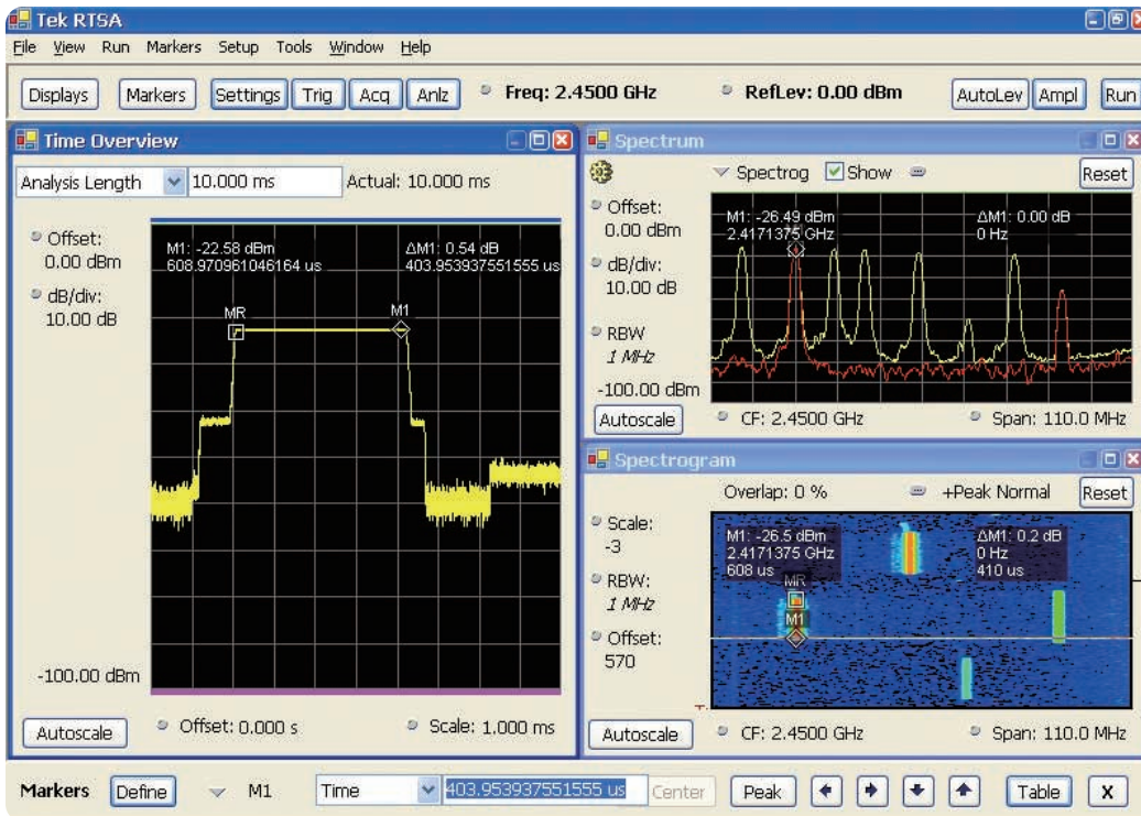
▶ 図6：Bluetooth®のホッピング・シーケンス。左から時計回りに、時間オーバービュー、スペクトログラムのある瞬間のスペクトラム、スペクトログラム。時間とともに変化するホッピング・シーケンスの測定が可能です。時間または周波数で自動的に時間相関が取られる複数のドメインでマーカーを使用し、DPX表示ですばやく問題を特定することができます。
