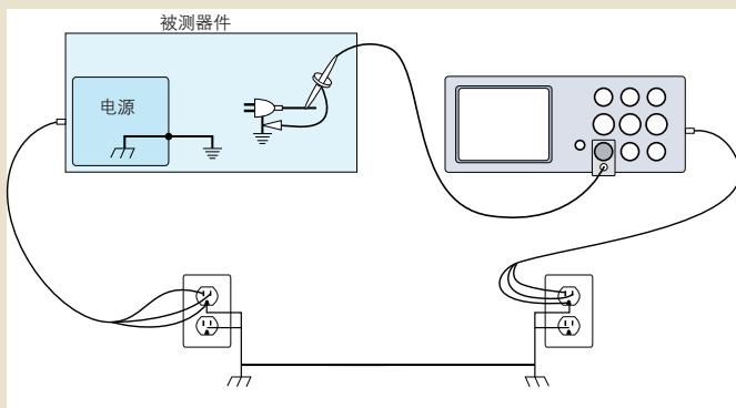
把示波器探头地线连接到被测电路上，如果电路“接地到”接地装置，那么会产生接地环路。
