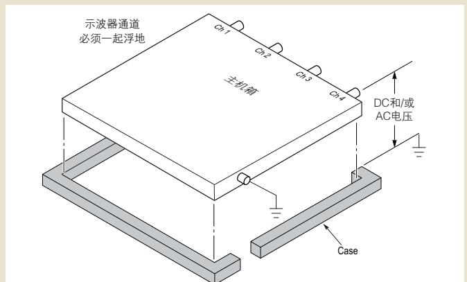
与传统台式示波器结构相比，这种隔离通道结构中的电压参考没有在仪器内部连接在一起。因此，每个输入的参考点必须连接到一个参考电压上。独立浮地隔离输入仍有寄生电容耦合。这可能会发生在输入参考点和环境之间，及输入参考点之间。基于这一原因，建议把参考点连接到系统接地或另一个稳定电压上。如果输入的参考点连接到高速和/或高压信号上，那么您应该了解寄生电容。
