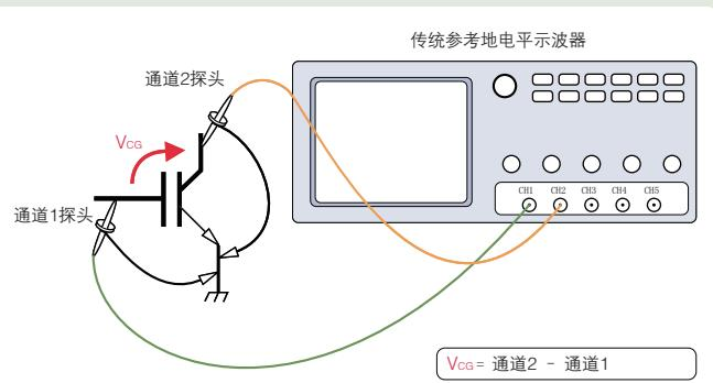
► 测量参考地电平电压的两只探头实例
