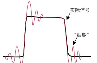
▶ 寄生电感和电容导致的振铃使信号失真，使测量无效
