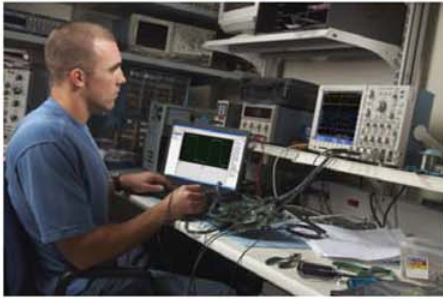
针对常用标准执行串行调试, 包括 CAN, LIN, FlexRay, I 2 C, SPI 等等。
