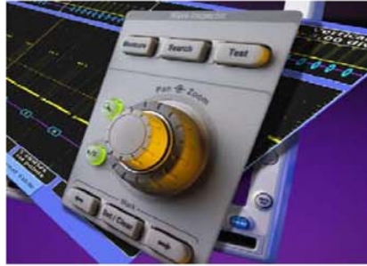
使用 Wave Inspector®, 简便地进行缩放、平移、搜索、设置用户标记、移动。
