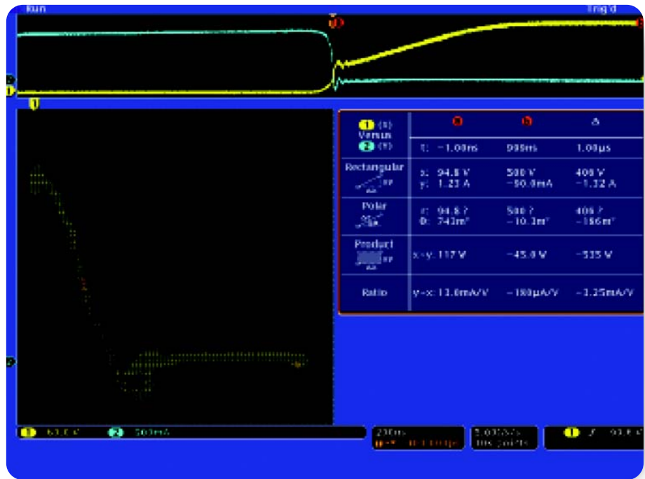
► 图 10. SMPS 中 Toff 跳变的 SOA 曲线。可以把这些曲线与开关设备制造商公布的数据进行比较
