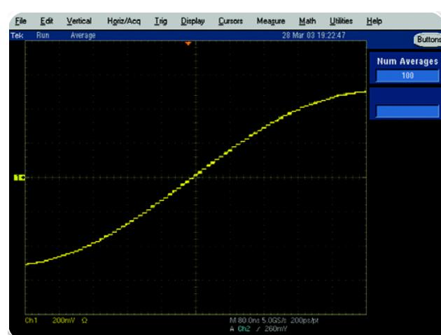
► 图 25. (上) 垂直分辨率低; (下) 垂直分辨率高。垂直分辨率决定着复现的波形的幅度精度。
