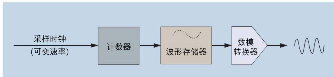
图2：数字信号发生器简化的方框图
