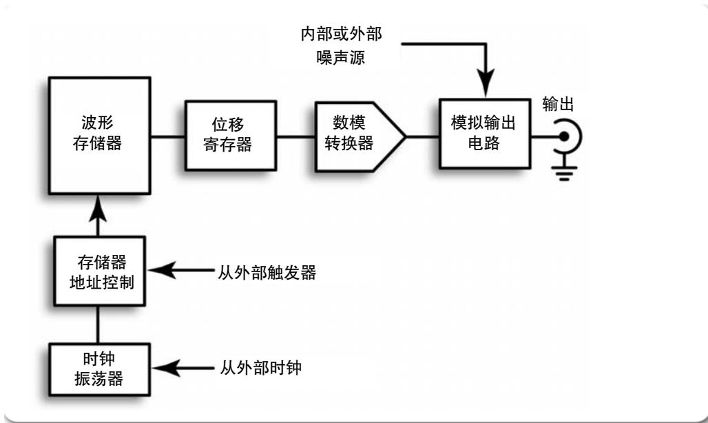
▶ 图 18. 任意波形发生器的结构 (简图)。
