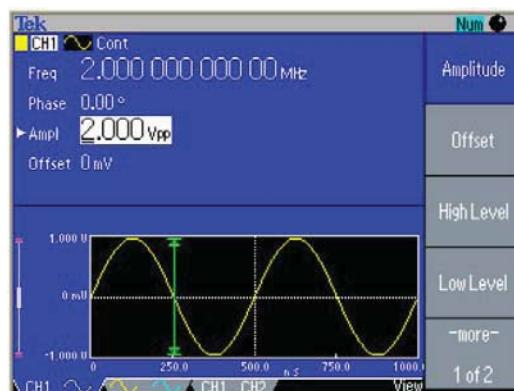
图4: AFG3000显示画面，显示了信号类型和参数。
