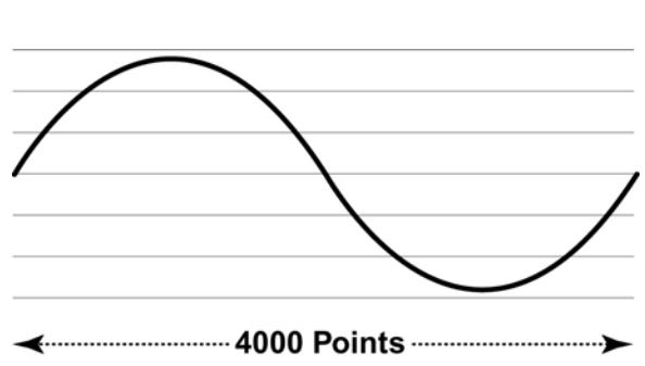
▶ 图 22. 在 100 MHz 的时钟频率时，一个 4000 点的波形作为 25 kHz 的输出信号传送。
