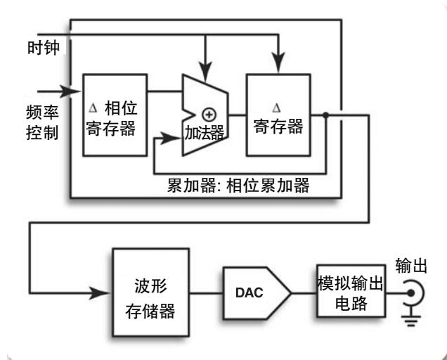
▶ 图 16. 任意/函数发生器的结构 (简图)
