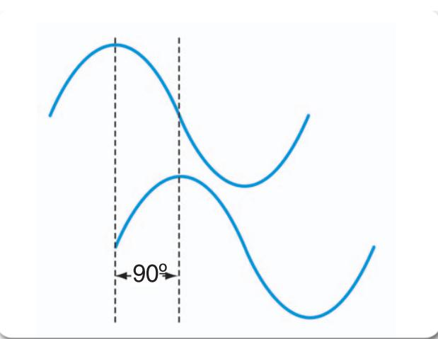
► 图4. 相移(也称为延迟)描述了两个信号之间的定时差。相位通常用度表示，如图所示，但在某些情况下用时间值表示要更合适。
