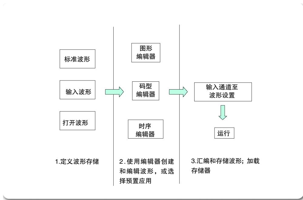
▶ 图 35. 使用 AWG 创建波形的步骤。
