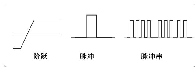
► 图 11. 阶跃、脉冲和脉冲串形状
