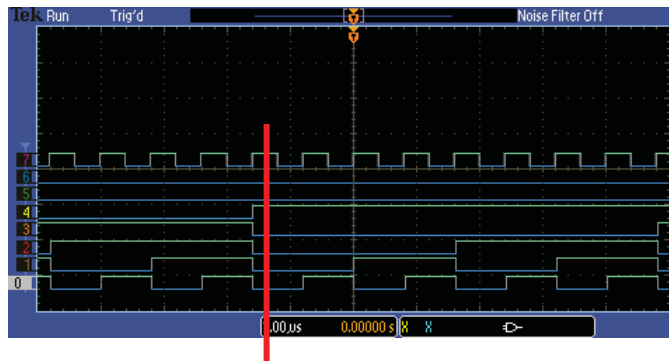
图1：并行总线线路实例
