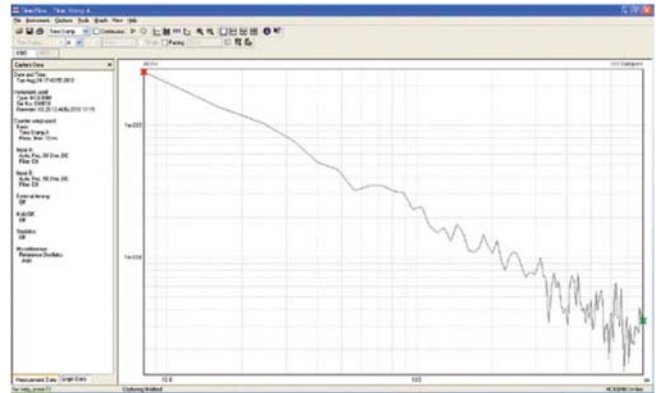
图 2. OCXO 的 ADEV vs t 的 TimeView™ 曲线。
