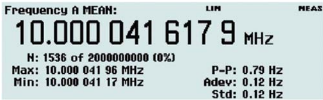
图 1. 使用 FCA3100 系列上的艾伦偏差(Adev)统计报告功能, 识别短期不稳定性。
