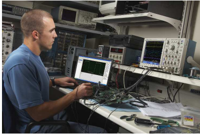
대중화된 표준을 위한 직렬 디버그 수행 (CAN, LIN, FlexRay, I 2 C, SPI 등)
