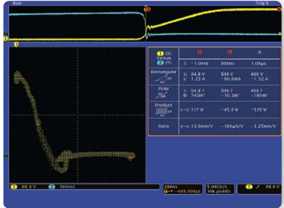
▶ 그림 10. SMPS에서 Toff 트랜지션의 SOA 플롯. 플롯은 스위칭 장비 제조업체에서 공개하는 데이터와 비교될 수 있다.
