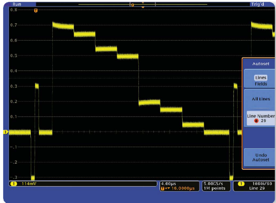
► 圖 7 4000 系列 Autoset 功能，讓視訊示波器只要一個按鈕就可設定所有功能。
