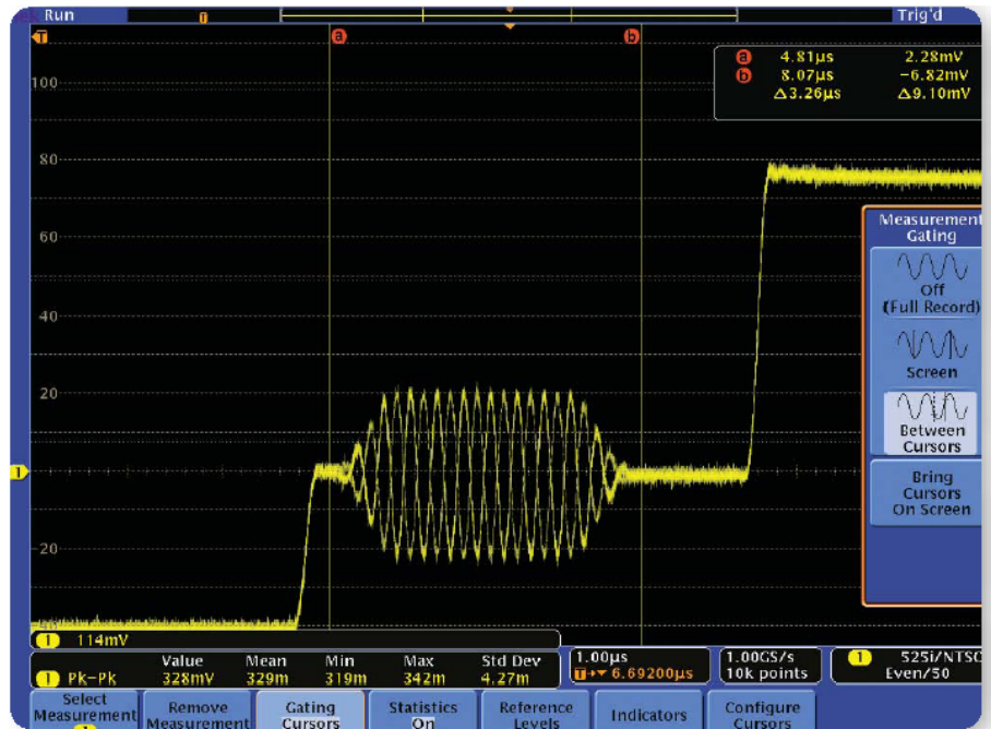
► 圖 10 NTSC 訊號的振幅量測例子。可利用示波器的峰對峰量測功能，量測色彩脈衝的峰對峰振幅。而目前採用的波形區域量測，則是由游標來控制。
