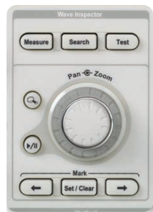
▶ 図6: Wave Inspectorは、アナログ・データのみならず、デジタル・データにも対応。必要な箇所を絞り込み、効率よく解析
