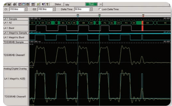
▶ 図5：TLAシリーズ・ロジック・アナライザによるタイミング解析
