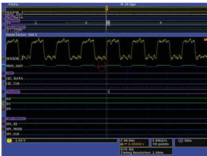
図6. Wave Inspectorによって検出されたMUX_OUT信号のグリッチ
