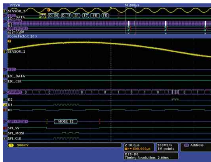
図4. Wave Inspectorでズーム表示したパケットの詳細
