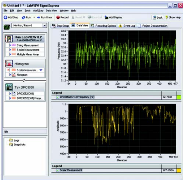
图 5. Signal Express 从泰克 DMM4050 和 DPO3052 中采集数据。
