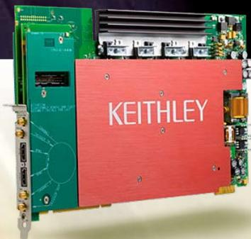
PMUは、1Ω未満から1GΩを超える値まで、広範囲の抵抗に対するパルスI-V測定に使用できます。オプションの4225-RPM型リモートアンプ/スイッチを使えば、1GΩを超える抵抗も測定できます。PMUに内蔵されたオートレンジ設定機能は、センサ出力の測定など、外部要因の関数として変化する可能性がある抵抗の特性を評価する場合に非常に有効です。
