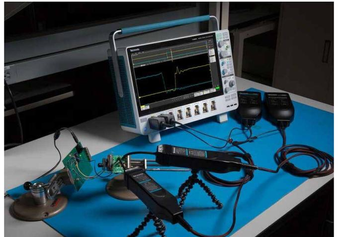
图 4. 许多电源拓扑要求在存在大的共模信号时测量小的差分电压。例如，半桥开关电路上管的 VGS 和 VDS 通常会相对于地电平上下移动几百或几千伏的电压。IsoVu™ 隔离测量系统可以与 4 系列 B MSO 结合使用，提供超高共模抑制功能。
