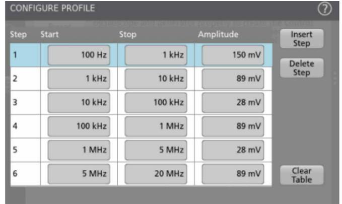
图 19. 振幅自定义曲线可用于改善测量的信噪比 (SNR)。此方法支持在 DUT 对干扰敏感的频率上应用较低的振幅，而在 DUT 对干扰不太敏感的频率上应用较高的振幅。
