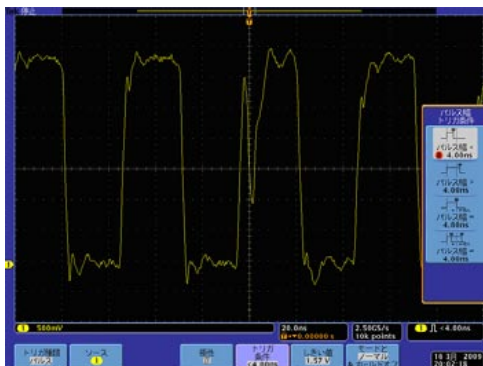
画面4：パルス幅トリガ条件により、ごく幅の狭い異常を確認することができる
