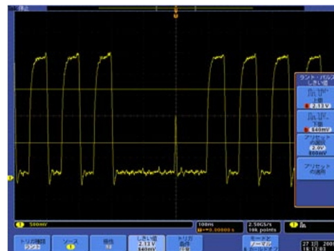
画面5：上下幅を持たせたトリガ条件により、振幅の小さな異常波形を確認することができる
