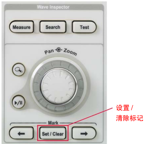
图 2B. 专用前面板旋钮，设置 / 清除标记，并在标记间导航。
