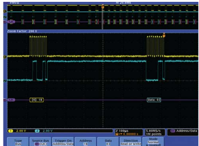
图2. 浏览I 2 C总线的长采集数据。
