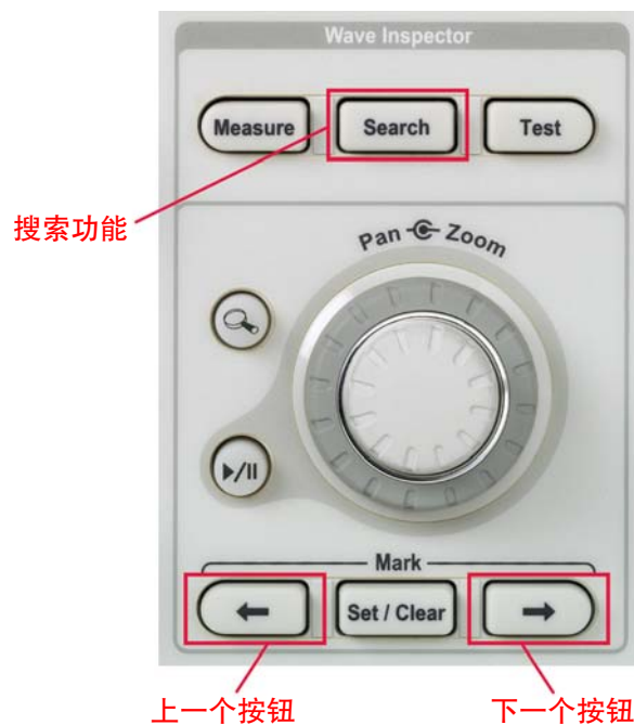
图3A.Wave Inspector®强大的搜索功能可以找到采集中每次发生的、用户指定的事件。
