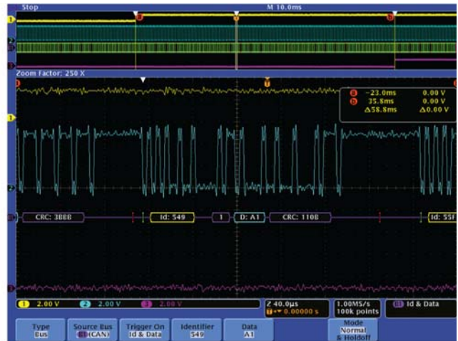
图 3. 把标记放在波形上，协助测量 CAN 总线上的时延。
