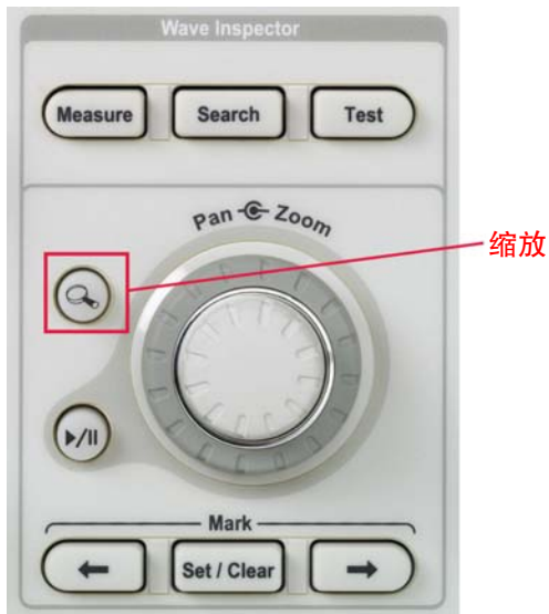
图1A. Wave Inspector提供了专用前面板缩放和卷动旋钮。
