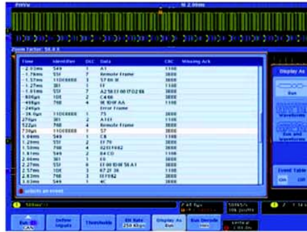
CAN 事件表, 显示总线内容, 简便地与软件列表进行对比。
