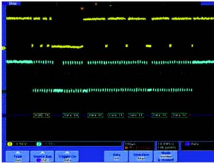
触发经过 I 2 C 总线上的特定数据包。
