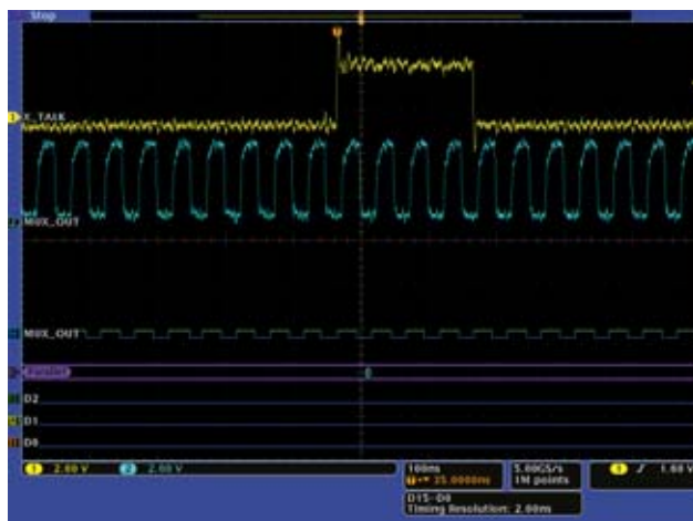
■ 图 9. 在改动 PCB 后，串扰消失了。
