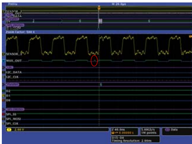
■ 图 6. Wave Inspector 揭示了 MUX_OUT 信号上的毛刺。
