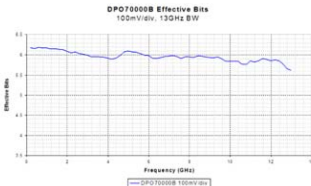
■ 图 3. DPO70000B 在 100mV/div 下的有效位情况图
