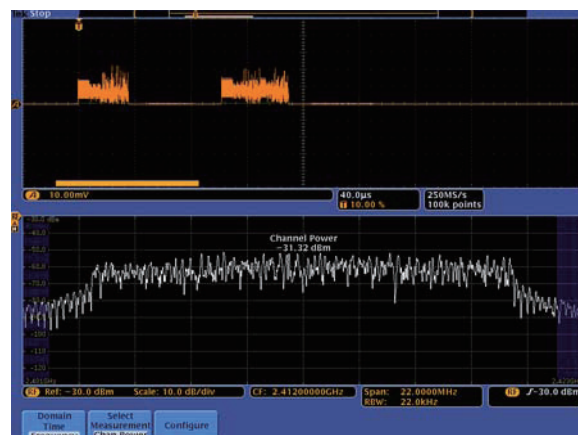
自动测量WiFi传输中第一个突发的信道功率
