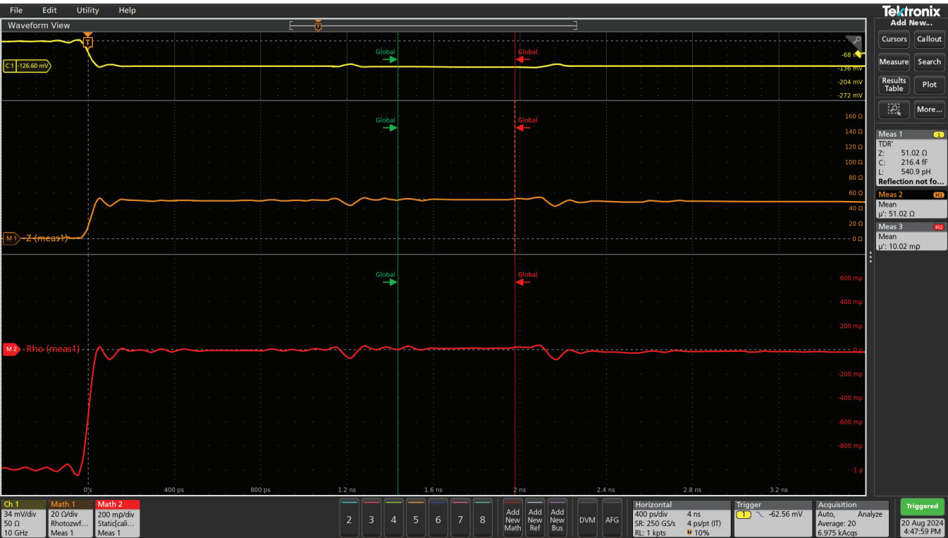
图 19. 被测微带线的测量值为 51.02\Omega 。根据参考测量应用校正时，校正值为 52.15\Omega 。
