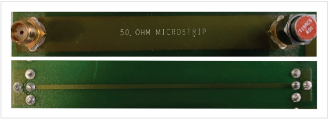
图 17. 50Ω 微带线，俯视图和底视图。
