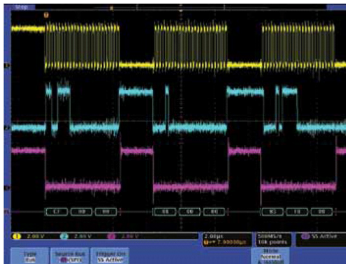
圖 12. 擷取經由 SPI 匯流排的合成器配置訊息。
