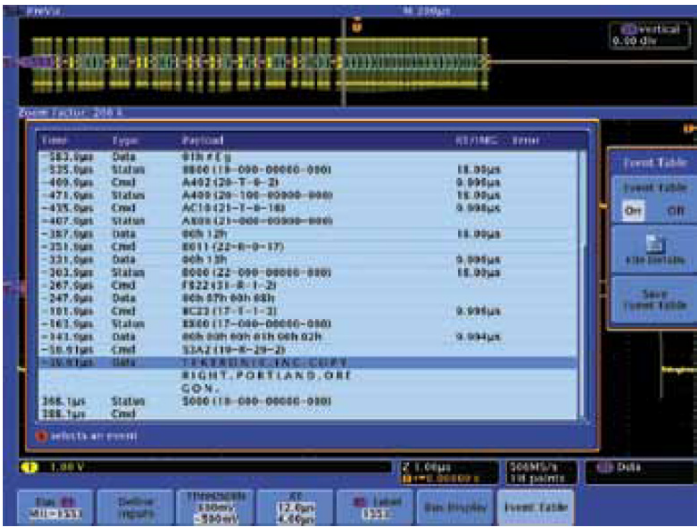
圖 39. MIL-STD-1553 匯流排已解碼顯示畫面。
