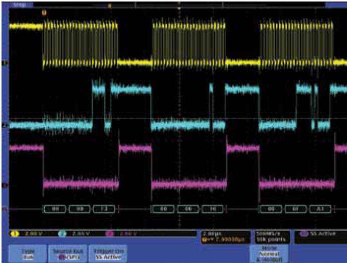
圖 13. 正確的合成器配置訊息。
