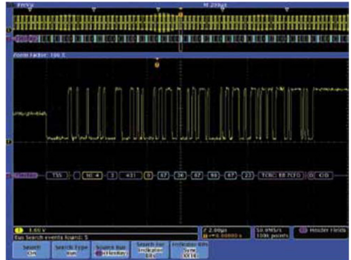
圖 42. 在訊框 ID 和週期數觸發，在擷取資料中搜尋啟動訊框。
