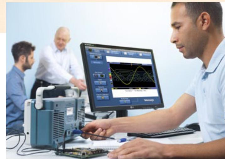
標準介面包括 GPIB、RS-232、USB、乙太網路和 LXI，可連結至網路通訊模組。對 USB 隨身碟而言 USB 是實用的裝置，可儲存波形、擷取和設定。PictBridge 可讓示波器如數位相機般運作。VGA 可連接至外部監視器。
