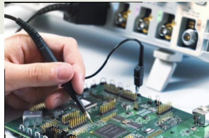
**探測解答：**欲量測電壓、電流或兩者？您訊號的頻率是多少？振幅多大？DUT 具低或高的源阻抗？您需要進行差動式量測訊號嗎？您需要做的事是決定適用的探棒。
