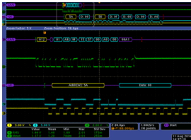
図 3. CAN/I 2 C デコード機能により、迅速なデバッグが可能に
