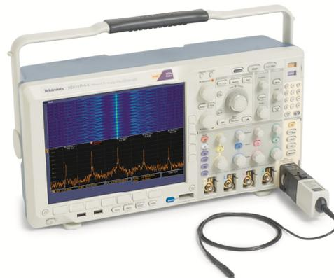
MDO4000シリーズとTPA-N-VPI型変換アダプタを使用することで、DC出力に直接プロービングしてDC-DCコンバータのスペクトラム成分が直接観測できる
