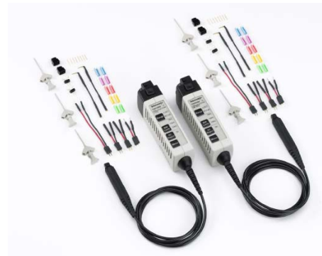
代表的な差動プローブ TDP1000型／TDP0500型
