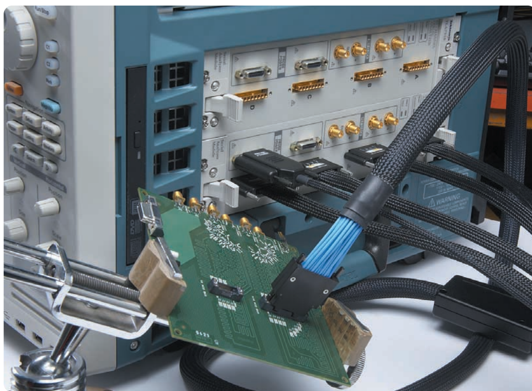
▶ 図31：回路基板表面の専用テスト・パッドに接続したMid-busシリアル・プローブの例。基板上での面積をとりません。
