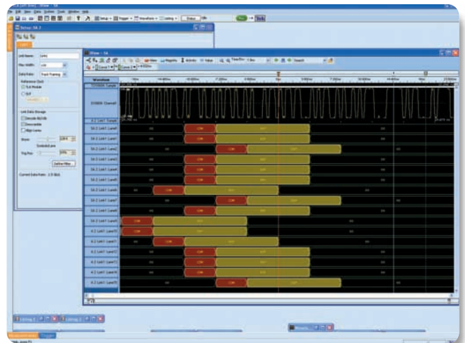
▶ 図34：デジタル波形で表示された、時間を合わせたパケット・データ。アナログ波形と相関がとれています。従来のロジック・アナライザのタイミング表示と同じですが、デコードされたシリアル・データが表示されています。
