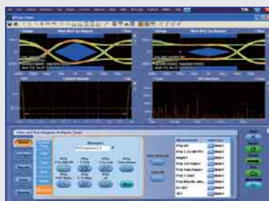
PCI-SIG規格に適合したテストが可能（DPOJET、またはRT-Eye、あるいは双方が必要）
