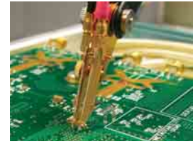
P7500シリーズP75PDPM 比較的容易なテスト・パッドからアクセスが難しい高実装密度回路まで、各種の測定ポイントにアクセスできます。
