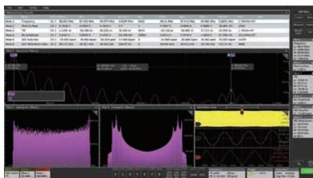
スペクトラム・クロック信号の解析。98MHzのクロックで39kHzの三角波変調が表示
