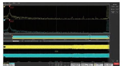
マルチ・チャンネルのスペクトラム表示。最大8チャンネルのスペクトラム表示が可能
