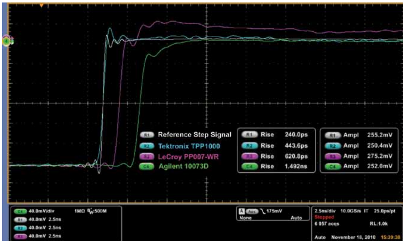
图 1. 泰克、力科和安捷伦标配无源电压探头的上升时间
