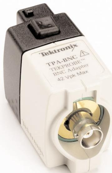
▶ TPA-BNC TekProbe-BNC Level 2와 TekVPI 프로브 인터페이스 어댑터
