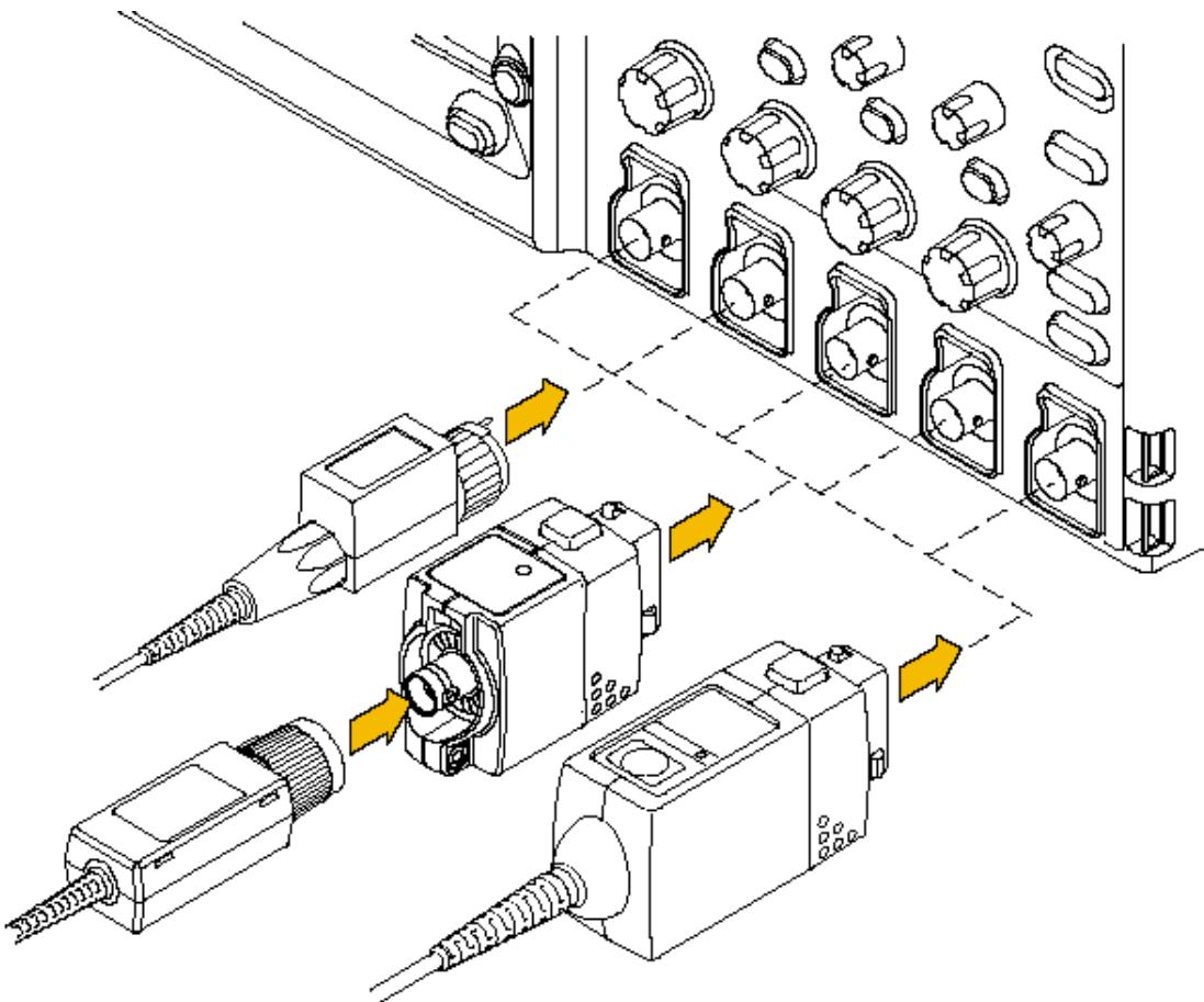
▶ 원쪽에서 오른쪽으로 – 일반 BNC 또는 7000 시리즈 또는 TekProbe-BNC Level 1 연결, 신형 TPA-BNC 어댑터를 통한 TekProbe-BNC Level 2 연결, 새로운 TekVPI 연결
